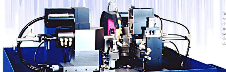
Die einfach zu bedienende Mikroprozessoren Steuerung kontrolliert den Schleifzyklus und das Ausfunken. Alle Maschinenfunktionen werden dabei am Pult aktiviert, der Zustand der Eingänge wird auf dem Display angezeigt.
