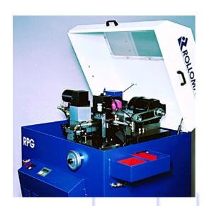
Optimaler Zugang der Maschine für rasches Einrichten und einfache Handhabung. Die Haube er-möglicht das Schleifen mit Oel für bessere Oberflächengüte. Sichere Durchmesserkorrekturen ohne Oeffnen der Haube oder Zyklus-unterbrechung.
