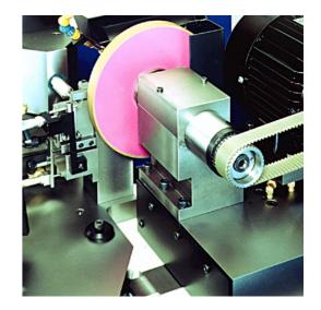
" V " Magazin, einstellbar über Mikrometerschrauben. Laden/entladen innerhalb 6 Sekunden. Die Teile werden mittels einer Plastikrinne entladen und können zu Kontroll-zwecken ohne Oeffnen der Haube sicher, ausserhalb des Schleif-raumes, aufgenommen werden.
